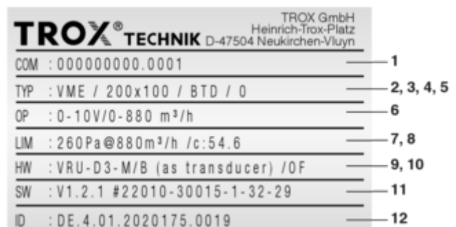
Abb. 3: Justageaufkleber Beispiel Serie VME mit Wirkdrucktransmitter BTM
