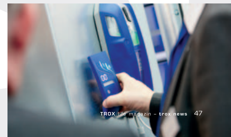
Praktisch: Das Anzeige- und Bedienelement der Rauchauslöseeinrichtung RM-O-M ist für eine Diagnose und Bedienung abnehmbar.
