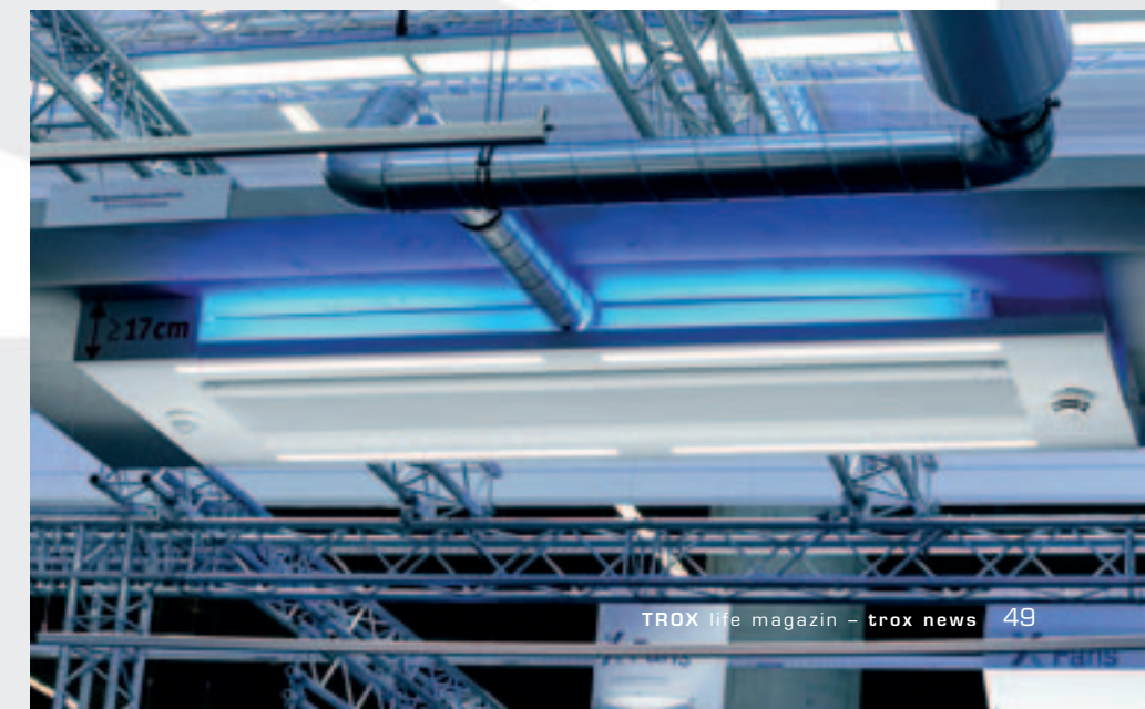
Der Deckeninduktionsdurchlass DID642 besticht durch seine flache Bauhöhe. Neue Düsengeometrien sorgen für geringere Druckverluste und ein breites Einsatzspektrum. Er kann freihängend oder in Raster- bzw. Gipskartondecken eingebaut werden.
