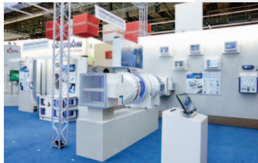
Versuchswand für Dauerfunktionstest der Stellantriebe nach Prüfnorm EN 1366-10 für Entrauchungsklappen und einen komplett angeschlossenen Kanal.
