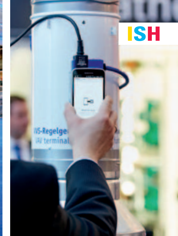
NFC-Technologie für eine Schnelldiagnose per Smartphone.
