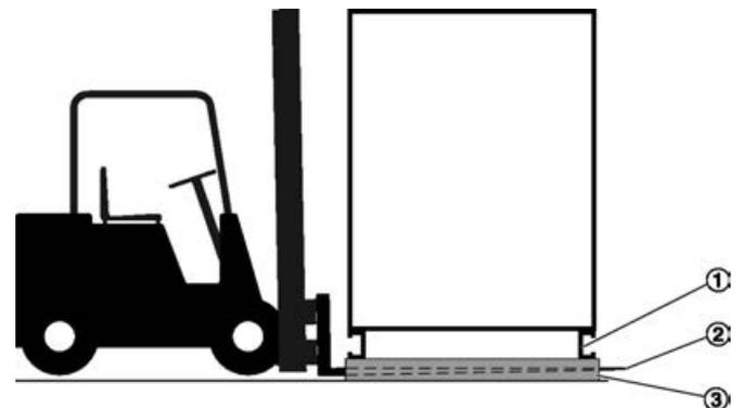
Abb. 4: Transport mit dem Gabelstapler
