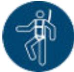
Der Auffanggurt dient zum Schutz vor Absturz bei erhöhter Absturzgefahr. Diese besteht, wenn bestimmte Höhenunterschiede überschritten werden und der Arbeitsort nicht durch ein Geländer gesichert ist.
