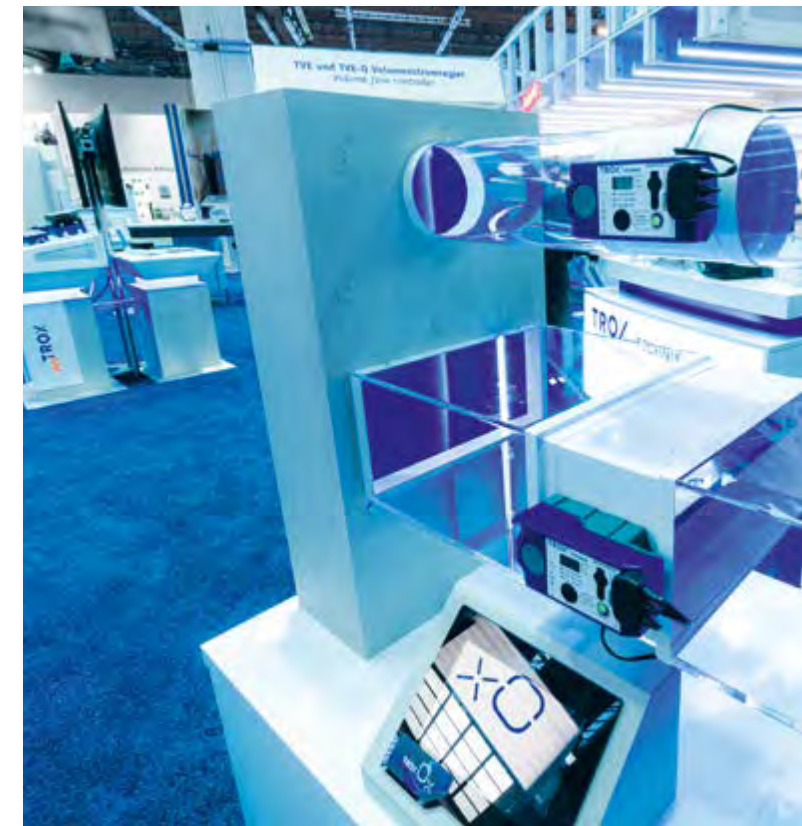
TVE-Q Volumenstromregler mit patentierter Achse, die den Wirkdruck direkt zum Sensor leitet. TVE-Q kommt so ohne externe Messschläuche aus.
